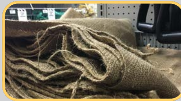
Burlap Bags para iti temporaryo nga estabilisasyon ti slope
